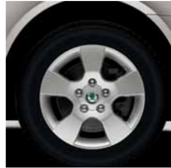
Disk z ľahkej zliatiny Helios 6,5J x 15" pre pneumatiky 205/60 R15 (CCR 600 004); pri použití pneumatík 195/65 R15 možno použiť snehové reťaze (CEP 300 002A)
