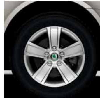
Disk z ľahkej zliatiny Pyxis 6,5J x 15" pre pneumatiky 205/60 R15 (1Z0 071 492A); pri použití pneumatík 195/65 R15 možno použiť snehové reťaze (CEP 300 002A)
